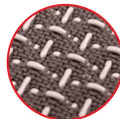
\* I test secondo la norma 20344:11 mostrano la traspirabilità 4 volte superiore al minimo richiesto per una calzatura di sicurezza.
